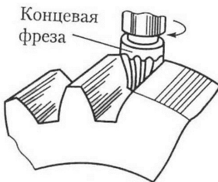
Рис. 3.7. Фрезерование зубьев цилиндрического колеса
