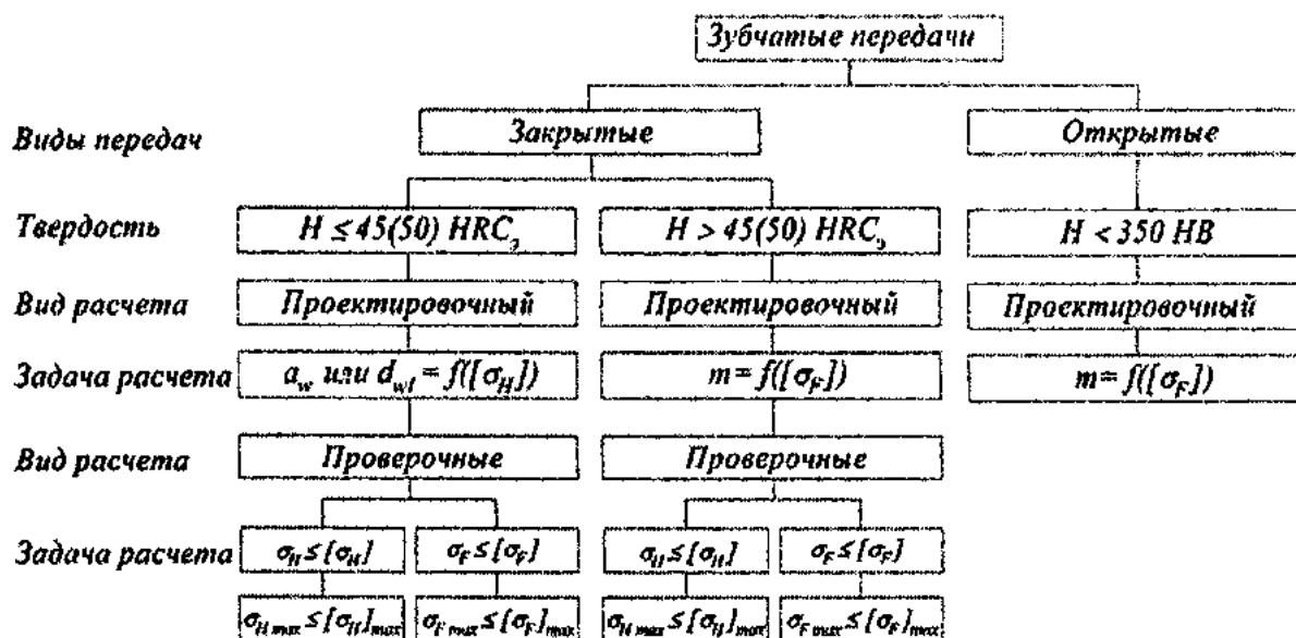
Рис. 1.2 Основные виды расчётов закрытых и открытых зубчатых передач
